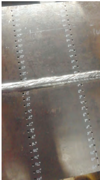
Рис. 1. Разметка баз для измерений сварного соединения
